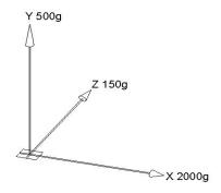
X: 2000g (peeling by 180°) X方向: 2000g (水平方向180度剥离)
